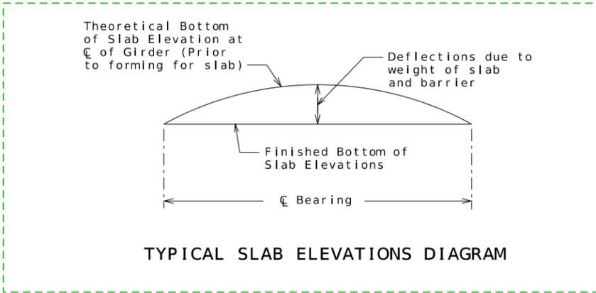
TYPICAL SLAB ELEVATIONS DIAGRAM
