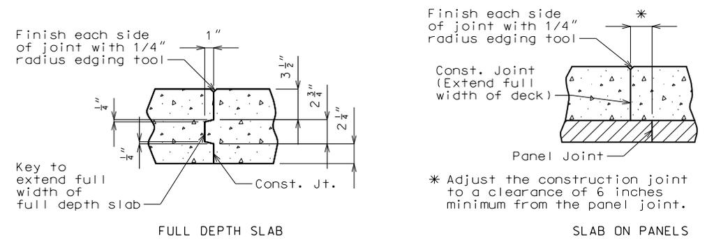
**SLAB CONSTRUCTION JOINT**
