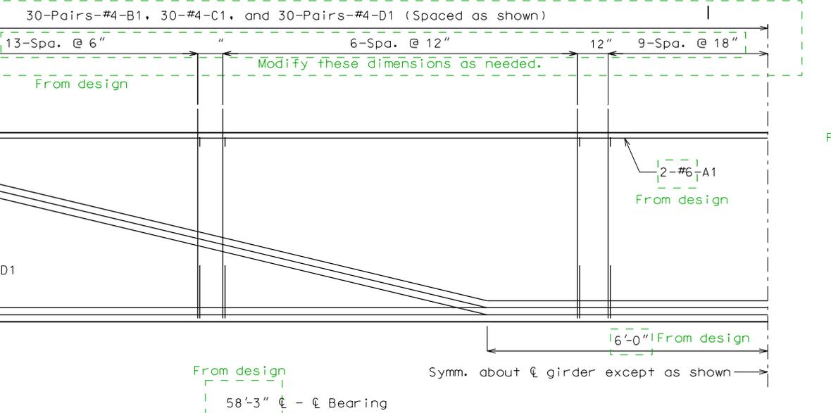
HALF ELEVATION OF GIRDER SPAN
